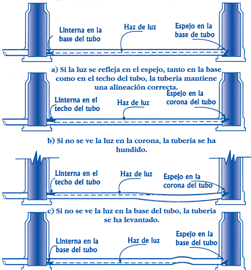
Figura 8 Control de alineación de las tuberías
