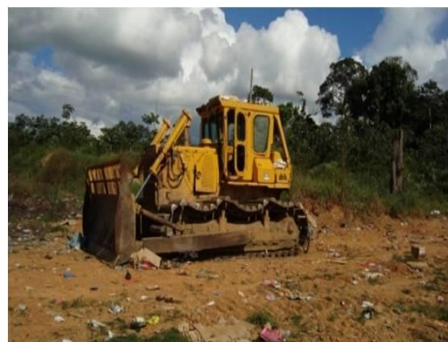
Cobija, maquinaria en mal estado
