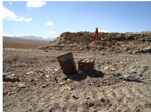
Captadores de Biogás
