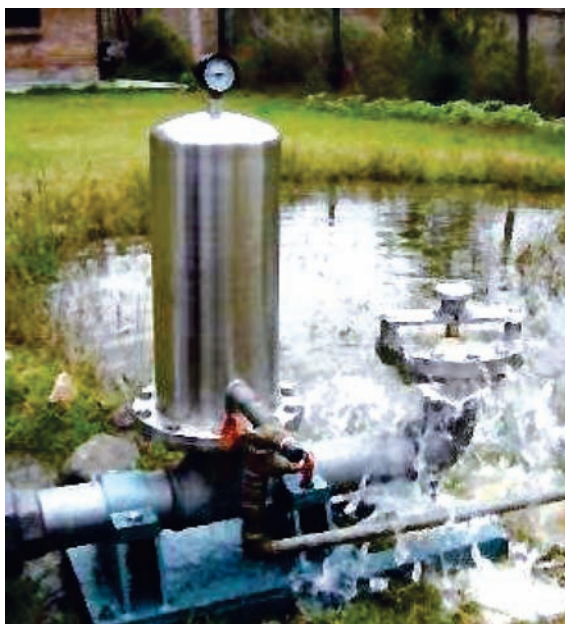
Foto 1.1 Bomba de Ariete en funcionamiento
