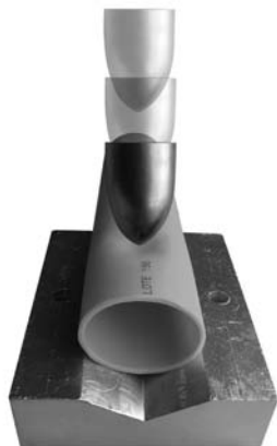
Foto 2.1 Prueba de impacto y compresión a la tubería
