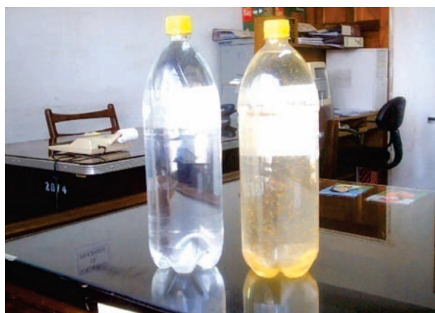
Foto 1. 2. Agua cruda y agua tratada
