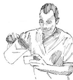
Prueba de los niveles de cloro usando un comparador
