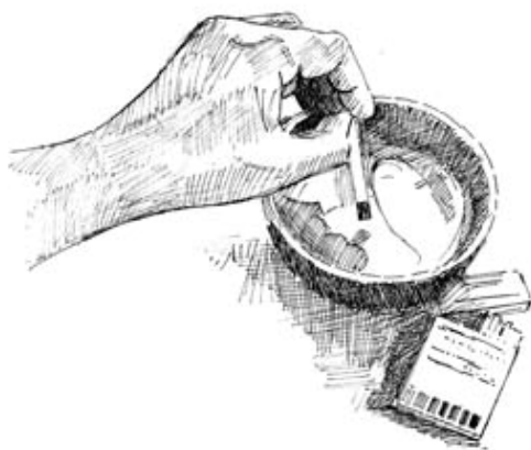
Prueba de los niveles de pH en el agua
