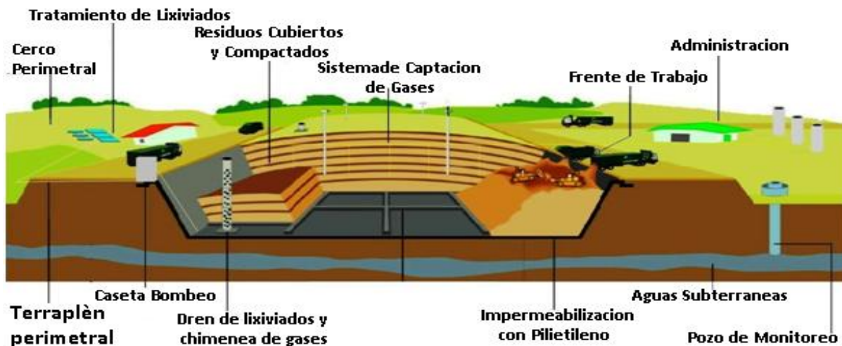
Figura 2.1: Componentes del Relleno Sanitario
