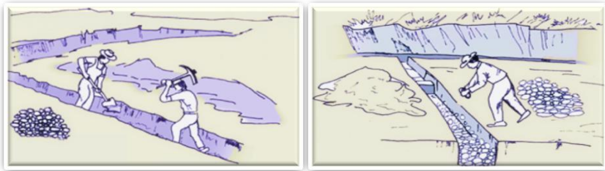
Figura 5.6: Construcción de Drenaje Interno para Lixiviados con Grava
