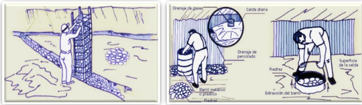
Chimenea de Puntales de Madera
