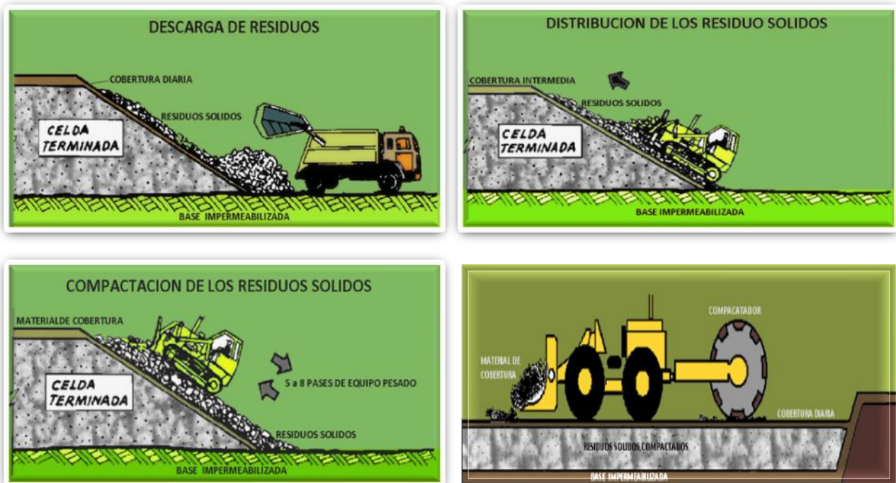
Figura 2.3: Relleno Sanitario Mecanizado
